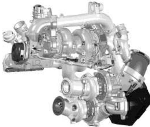
A eficiente solução de ponta R2S® da BorgWarner com quatro turbocompressores oferece um desempenho excepcional e contribui para melhorar a eficiência de combustível em até quatro por cento no novo motor 3.0 a diesel do BMW Group.
