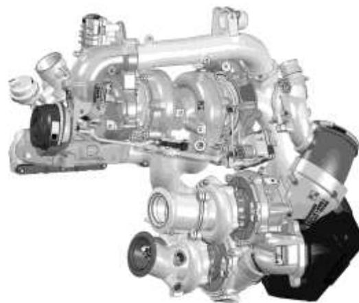
El eficiente sistema de impulso R2S<sup>®</sup> de BorgWarner con cuatro turbocompresores ofrece un rendimiento excepcional y contribuye a una mejor eficiencia de combustible hasta en un cuatro por ciento en el nuevo motor diésel de 3.0 litros de alta calidad del Grupo BMW.
