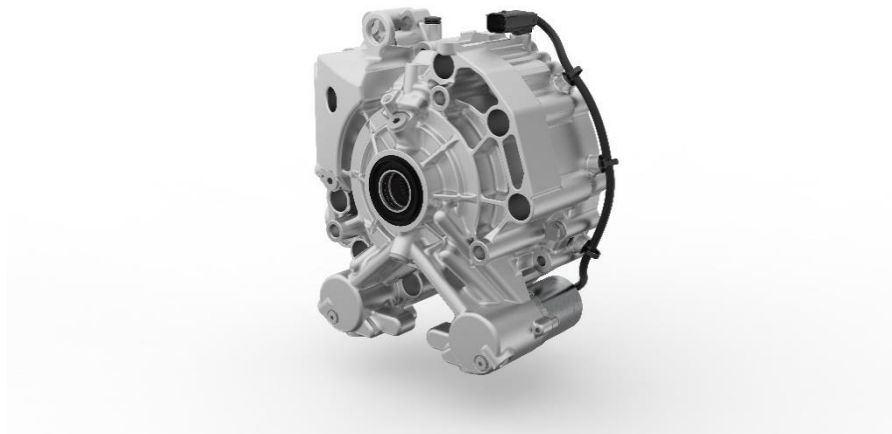
Système à double embrayage et vecteur de couple BorgWarner pour véhicules électriques
