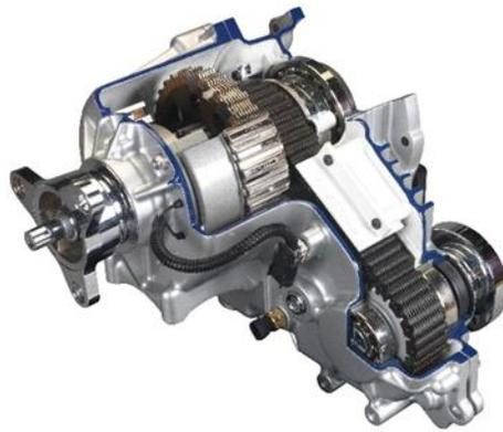
博格华纳配备了车辆动态控制系统的 Torque-On-Demand® 分动箱帮助后轮驱动的道奇挑战者实现全轮驱动功能，赋予车辆在任何天气和季节中的卓越驾驶体验
