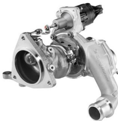
博格华纳为本田思域提供久经考验的排气泄压阀门式涡轮增压器，能迅速对发动机做出响应，提高发动机性能和能源效率，减少排放。
