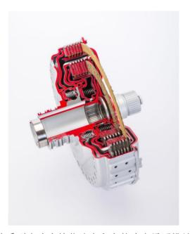
博格华纳全新的双离合器模块系列专为高性能跑车和高转速应用而设计,可显著提高燃油经济性,改善换档体验
