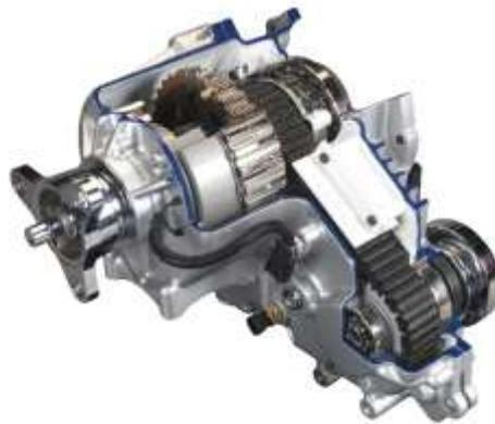
A caixa de transferência Torque-On-Demand® com a nova tecnologia de controle dinâmico do veículo (VDC) transforma a tração traseira do Dodge Challenger GT em um veículo com tração integral para uma experiência divertida em qualquer clima ou estação.
